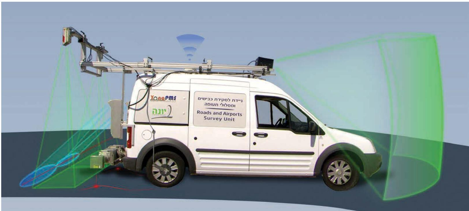
Veículo não especializado, montado com ferramentas de coleta de dados em campo
